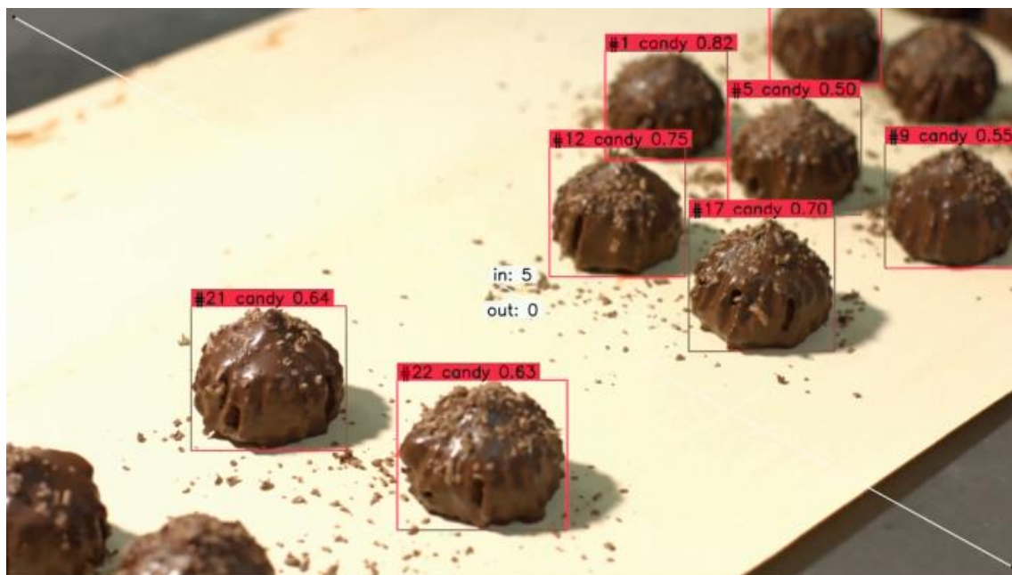
图 1.5 使用 YOLOv8、ByteTrack 和 Supervision 进行目标检测、跟踪和计数
